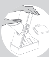
Placa de ajuste de espesor: parte delantera para 2 mm, la parte trasera para 4 mm.
